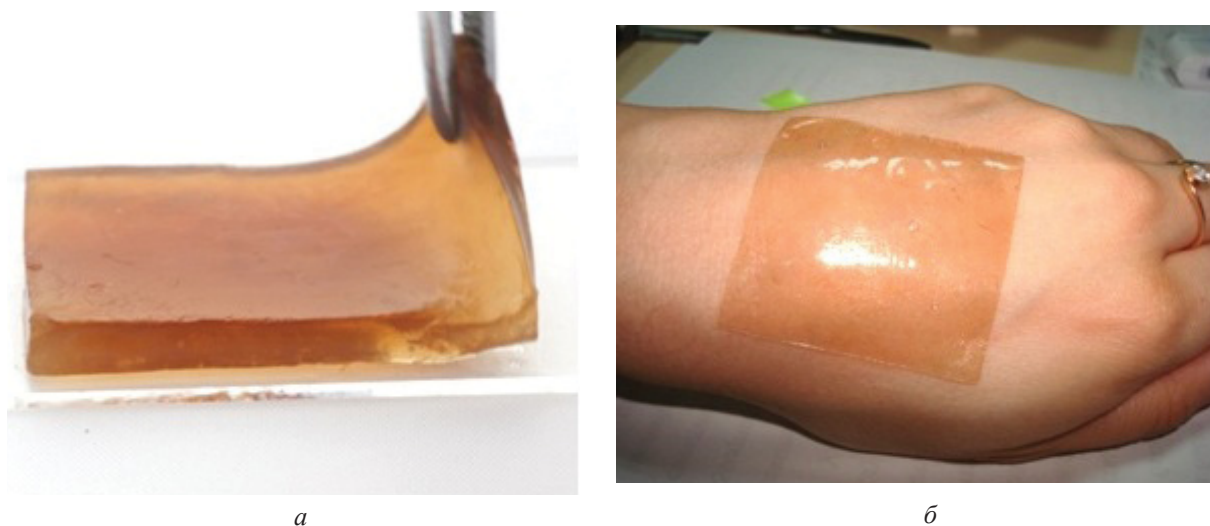
Рис. 1. Фотографии кремнийхитозансодержащих глицерогидрогелевых тонкопленочных пластин на основе аскорбата хитозана толщиной, мм: a – 5, б – 1
