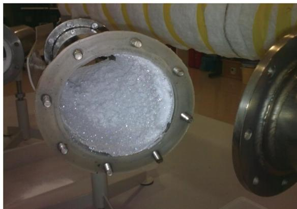
Рис. 4. Установка вакуум-термической очистки оксида мышьяка (III)
