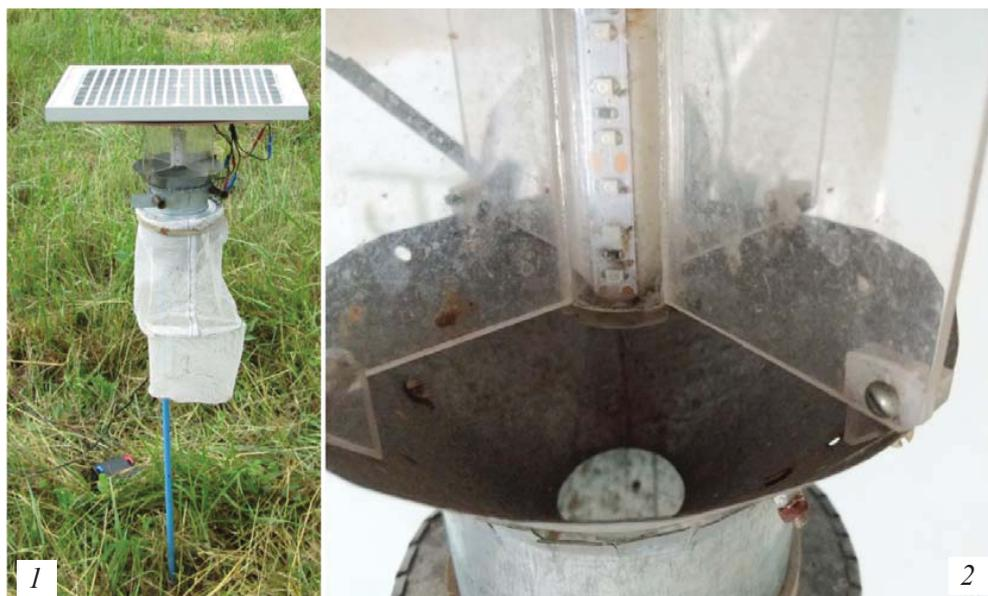
Рис. 1. Ловушка-аппликатор: 1 – общий вид, 2 – детали строения, видны светодиоды, пластиковые пластины и воронка насекомоприемника
