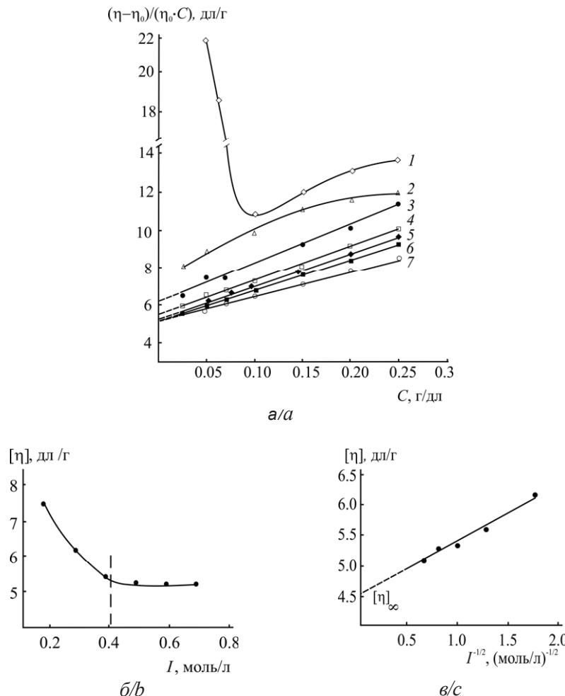
Рис. 1. Зависимости: а – числа вязкости растворов хитозана с  $\bar{M}_\eta = 700$  (1, 3–7) и 200 кДа (2) в 1.5% ГК при ионной силе среды (задаваемой введением NaCl)  $I = 0.19$  (1, 2), 0.29 (3), 0.39 (4), 0.49 (5), 0.59 (6) и 0.69 моль/л (7) от концентрации полимера; б и в – предельного числа вязкости растворов хитозана с  $\bar{M}_\eta = 700$  кДа в 1.5% ГК от ионной силы среды и от ее обратной величины
