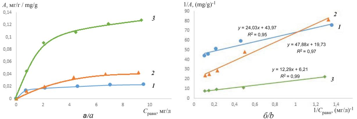
Рис. 9. Изотермы адсорбции метиленового оранжевого в нейтральной среде из раствора на сорбентах: 1 – 1-ГО, 2 – Fe-МБГО и 3 – Al-МБГО (а); изотермы сорбции метиленового оранжевого в нейтральной среде из раствора, представленные в обратных координатах в соответствии с уравнением Ленгмюра, на сорбентах: 1 – 1-ГО, 2 – Fe-МБГО и 3 – Al-МБГО (б)
