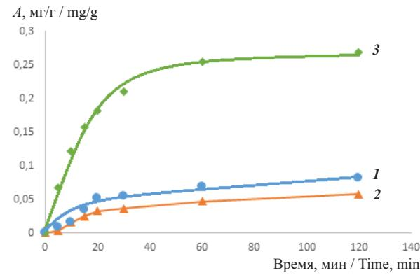
Рис. 5. Кинетические кривые адсорбции метиленового оранжевого из раствора в нейтральной среде на сорбентах:
