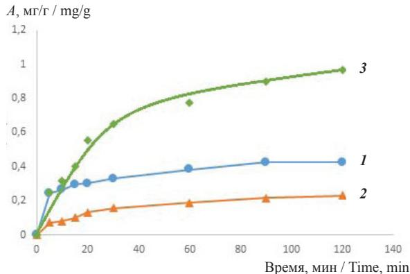
Рис. 2. Кинетические кривые адсорбции крезолового красного из раствора в нейтральной среде на сорбентах:
