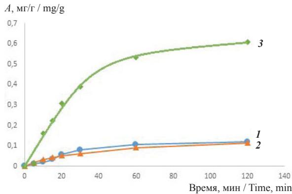
Рис. 4. Кинетические кривые адсорбции конго красного из раствора в нейтральной среде на сорбентах: I – 1-ГО, 2 – Fe-МБГО и 3 – Al-МБГО
