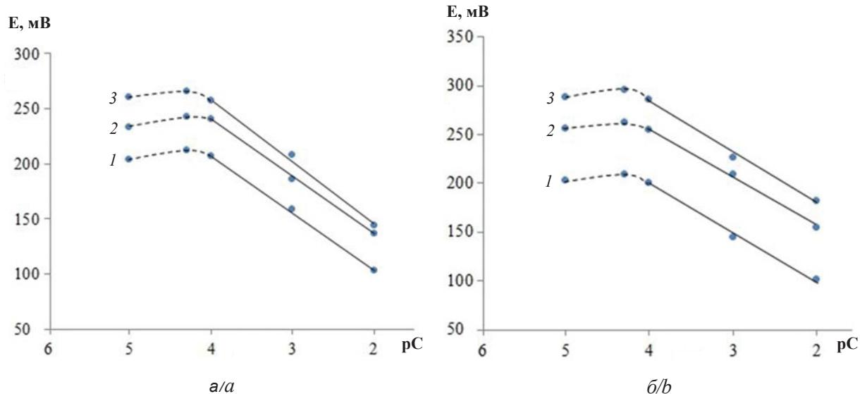
Рис. 1. Электродные функции модифицированных полианилином сенсоров на основе Ag(Cefur)<sub>2</sub>ТДА (1), Ag(Cef)<sub>2</sub>ТДА (2), Ag(Ceftx)<sub>2</sub>ТДА (3) в растворах цефотаксима (a), цефазолина (b)
