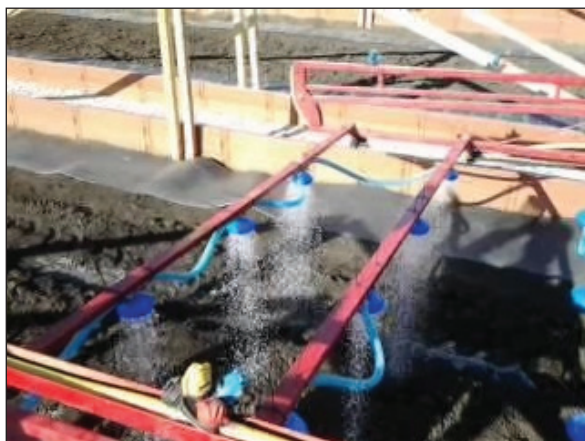
Рис. 1. Дозированный полив почвы с помощью навесного оборудования
