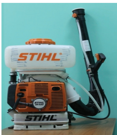
Рис. 5. Опрыскиватель «ранцевый» для внесения капсулированного штамма-деструктора
